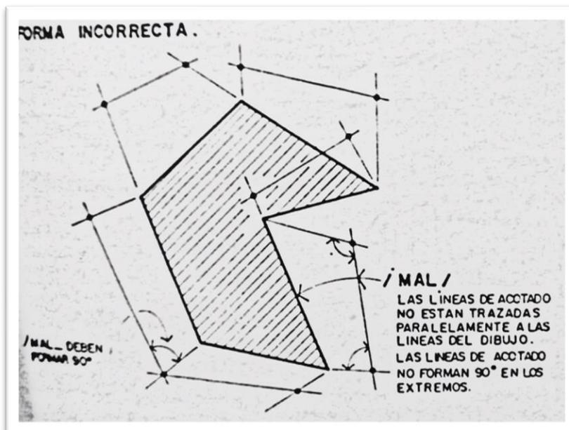
Aquí dos ejemplos de cómo acotar paralelamente al dibujo No. 1 y No. 2
