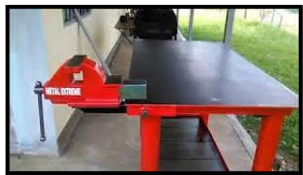
También tenemos el banco Auxiliar o transportador de herramienta, ya que nos sirve para brindarnos apoyo en el traslado de herramienta manual o eléctrica.
